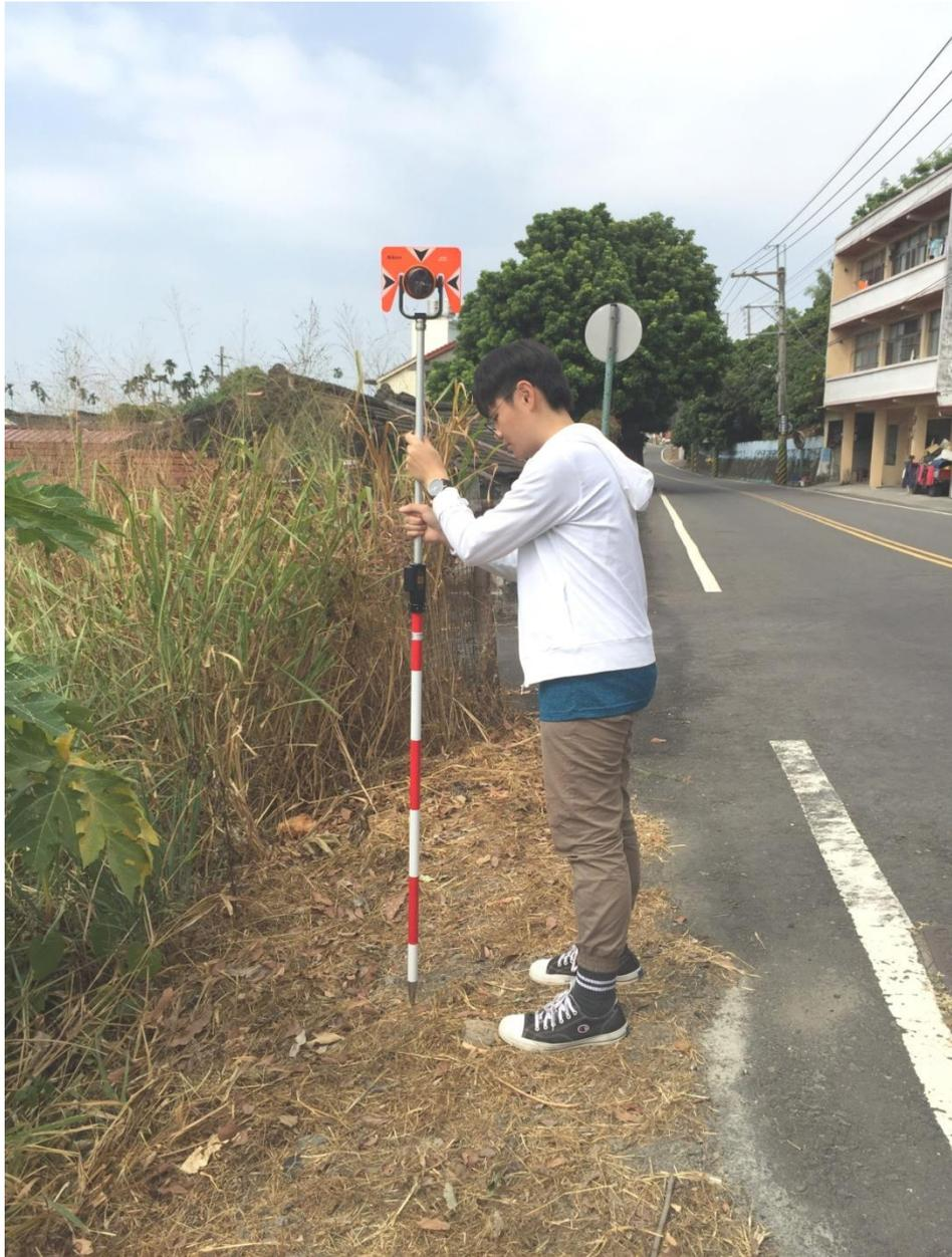
我正在使用標竿，上方的稜鏡搭配全站儀能建構斷層崖地形剖面圖。
