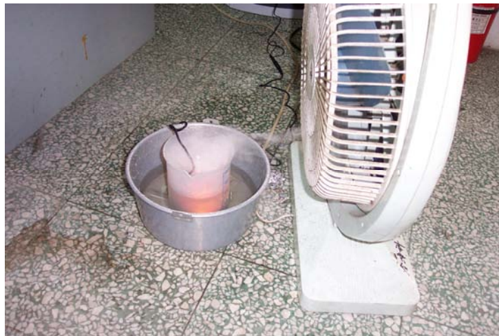
圖 7 測量霧化器每小時之霧化量
