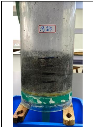
圖 7、乾淨的河沙過濾海水的器材
