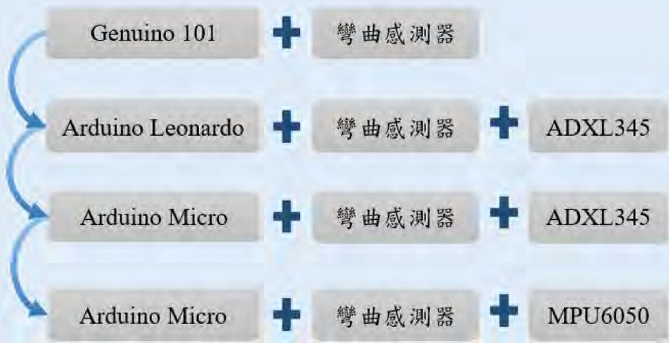
手套總共分成四個版本，每次更新中，嘗試不同開發版或感測器，讓手套更完善。每次改良後，使用KODU或Scratch 2設計遊戲，來進行功能實測，長者使用手套時，可以搭配使用，結合遊戲讓過程更有趣。
