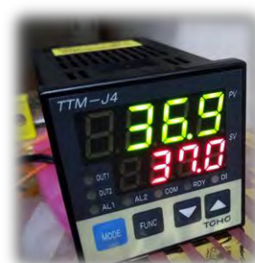
圖六：PID 溫度控制器 (圖六資料來源: 研究者拍攝)
