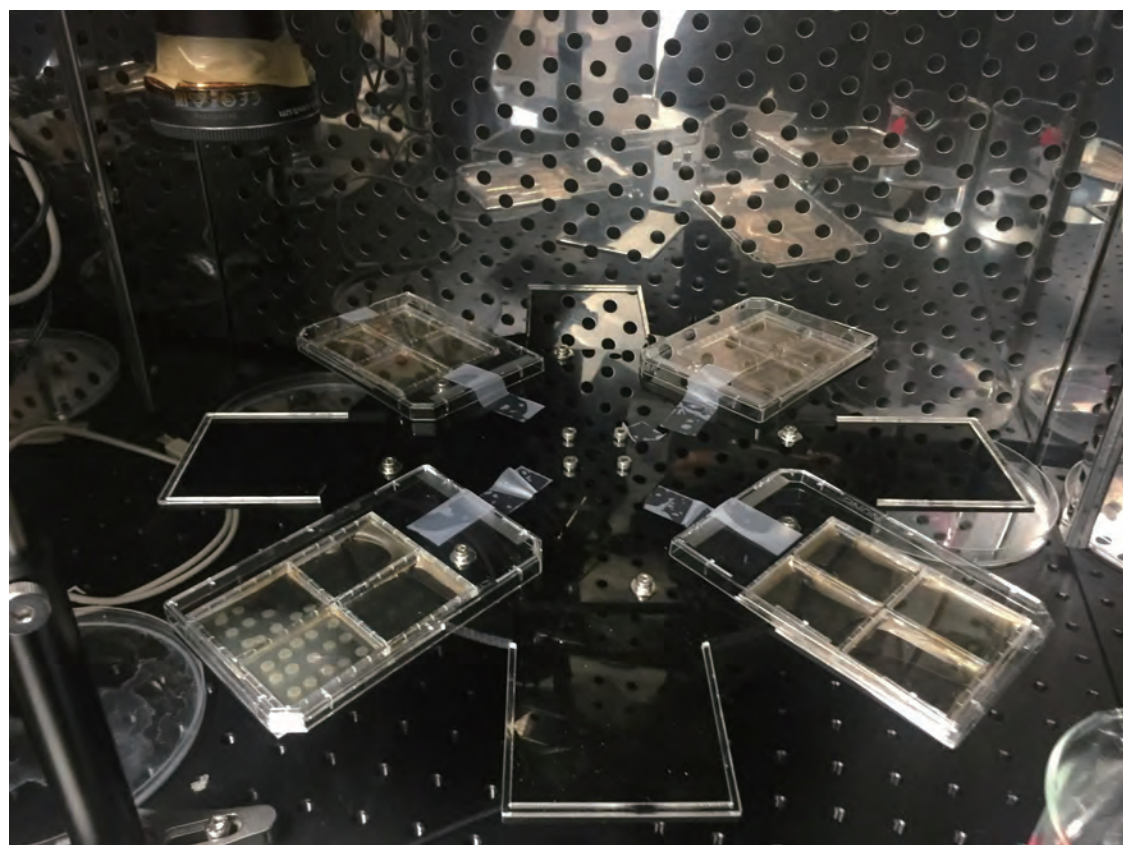
轉盤輪流拍攝四盤細菌盤 上蓋密封防風乾打洞透氣
