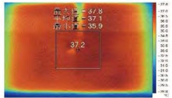
圖二十四：玻璃在紅外線攝像儀下溫度十分均勻 (圖二十一資料來源:研究者拍攝)
