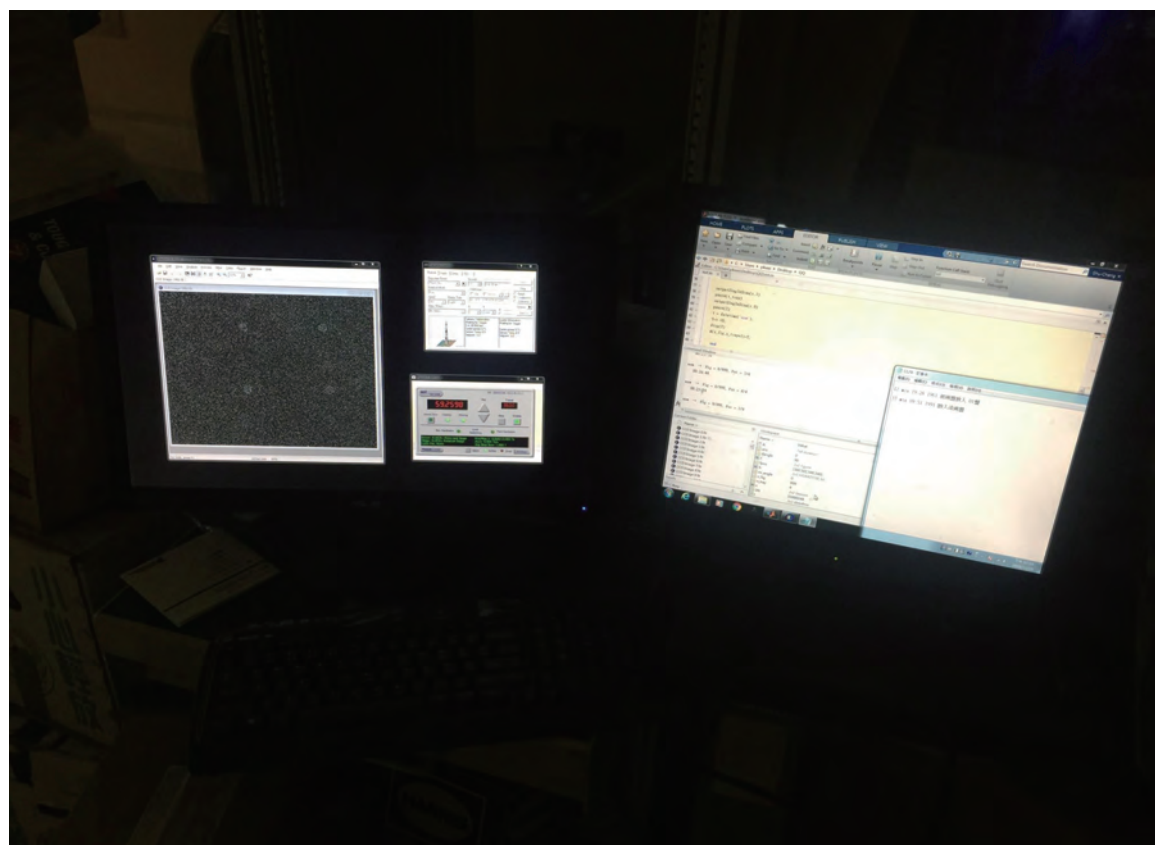
MatLab整合控制轉盤與相機 以OpenCV分析細菌亮度變化
