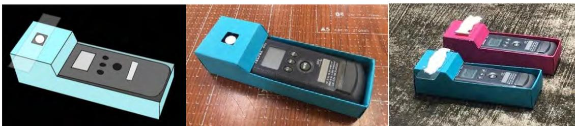
圖二十四 自製防曬乳戶外測量紫外光照度值裝置圖
