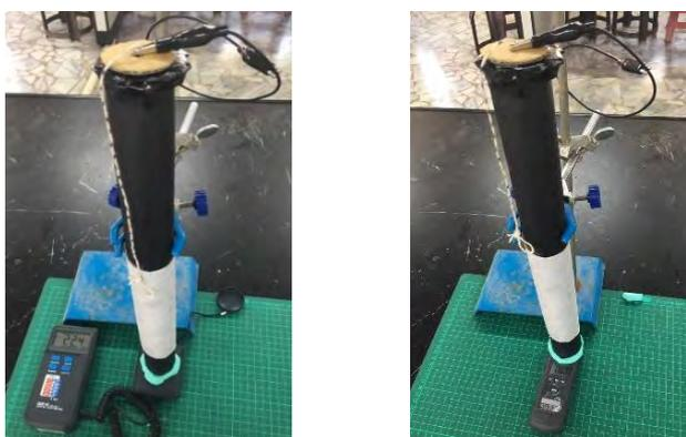
圖/測量電阻值和照度值的實驗暗室
