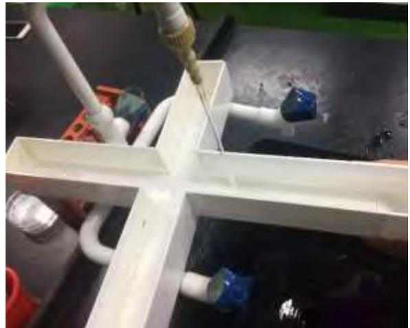
圖 10、測試迷宮漏水，若漏水以熱熔膠補強
