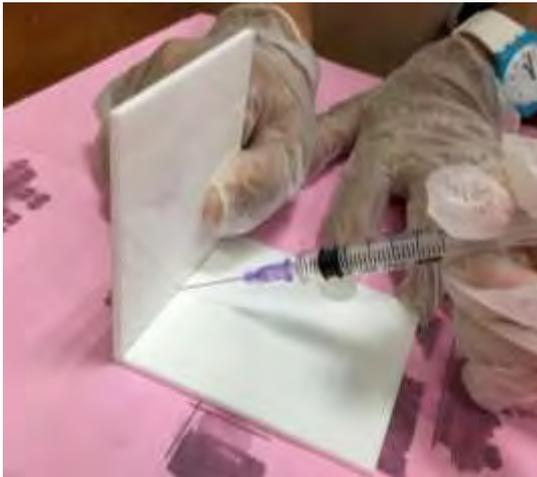
圖 9、使用氰仿連接壓克力板
