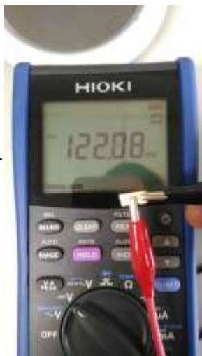
圖 11. 量測裝置在(25 °C)竹片兩端建立的電 壓為 122.1 mV
