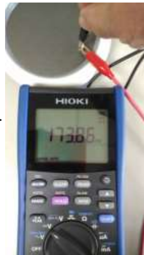
圖 12.將竹片一端放在 加熱板(118 °C)所建立 電壓為 173.8 mV
