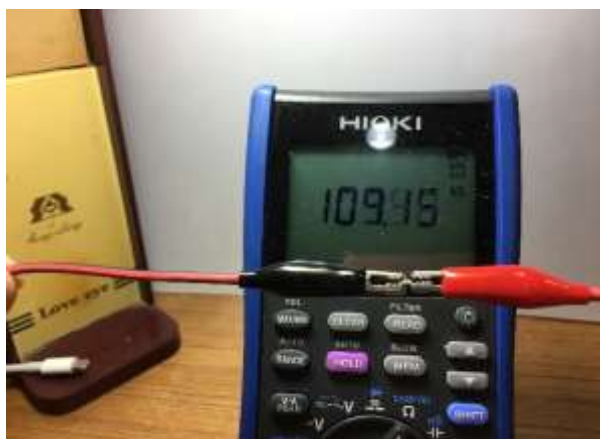
圖 21. InNPs Inserted 竹子內的電阻測量方法
