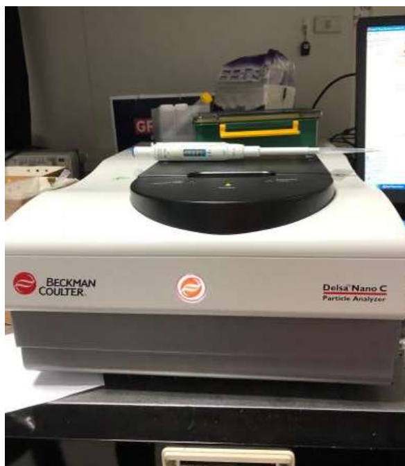
圖（8）. 圖為奈米粒徑分析儀，將含有FND 以及 Luc-FND 的溶液裝入玻璃光析管中，利用光線的繞射，測量 FND 和 Luc-FND 的粒徑大小。
