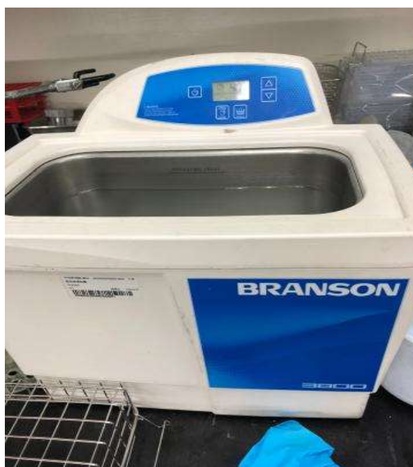
圖（7）. 圖為超音波震盪器，用來將FND均勻震盪於溶液中以及使 FND 與螢光素酶可以充分混合，讓螢光素酶均勻的覆蓋於液體中 FND表面。
