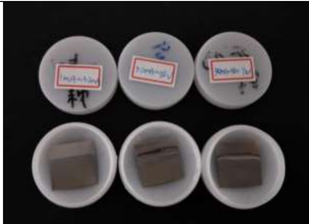
圖31 每20秒增1mA至30mA後，逐漸增壓至50V進行陽極處理法，其處理的鈦片表面情形
