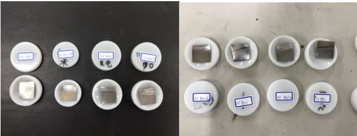
圖23 在最大電壓為40V及50V下進行二階段電壓/電流步進法，其處理的鈦片表面情形
