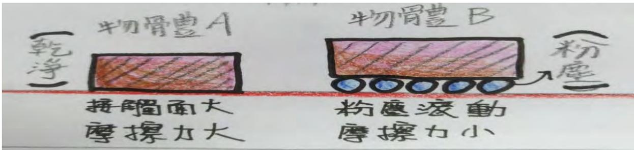
圖 6-5 灰塵對使介面摩擦力下降示意圖（研究者自繪）
