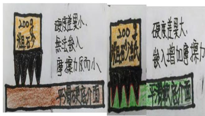
結果七：「硬質粗糙面/硬質粗糙面」紋路若卡住摩擦力較大。紋路無法卡住摩擦力小。
