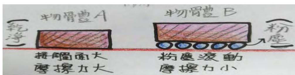
圖 4-10 接觸介面間灰塵對摩擦力影響關係實驗示意與假設圖（研究者自繪）
