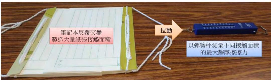
圖 4-7 本研究接觸面積與摩擦力關係之測量方式
