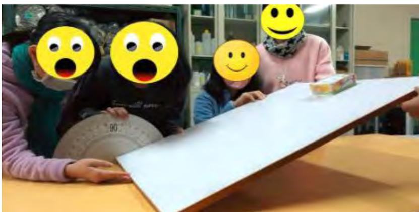
圖 4-9 量測置物平台滑落的坡度角，推算最大靜摩擦力
