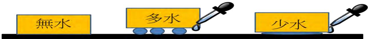
圖 4-11 接觸介面間水分多寡對摩擦力影響關係實驗示意圖（研究者自繪）
