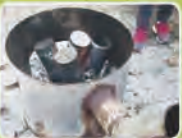
0個洞的鐵罐，燒製過程中蓋子因熱氣彈飛
