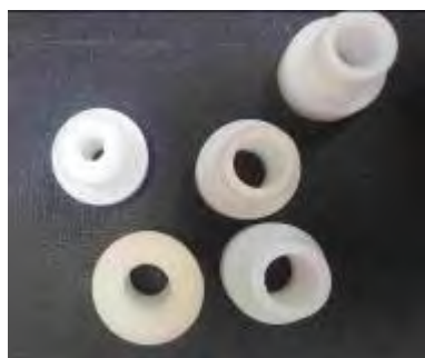
照片 3-1 沉水馬達出水口與水管的轉接頭
