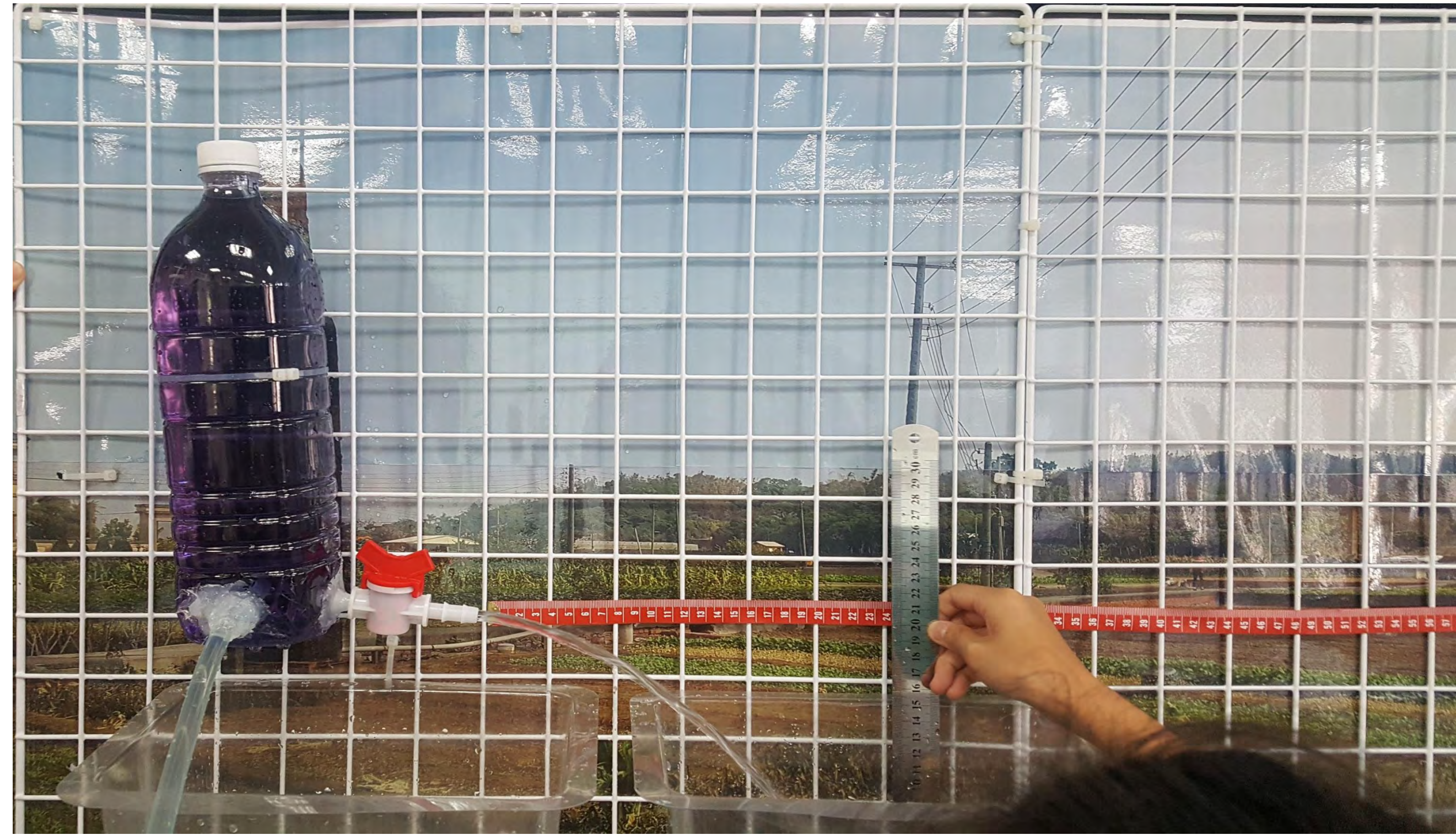
照片 5-10氣量0毫升時，20秒內灌溉水量與水柱噴出距離
