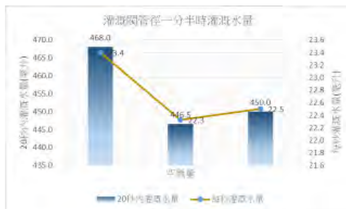
圖 6-11 單支水煙囪內空氣量不同-灌溉水量(灌溉閥 1 分半時)
