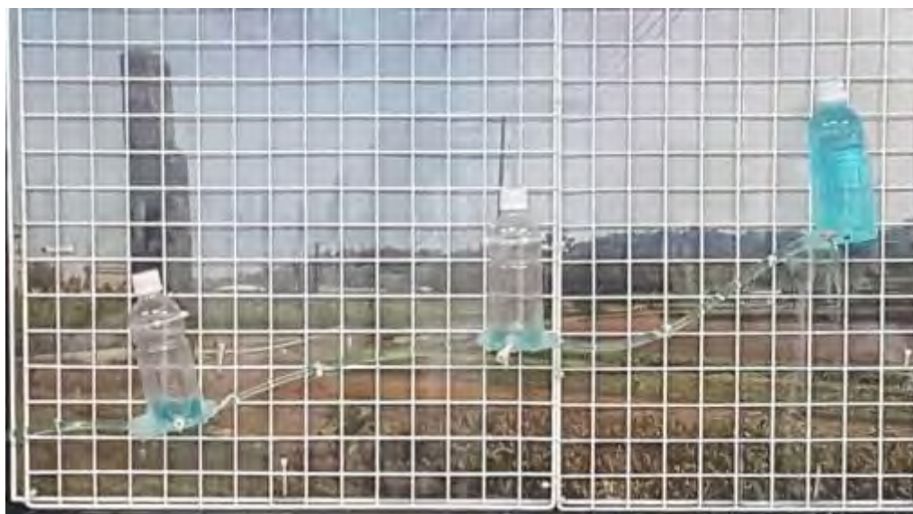
照片 5-8 輸水管內徑 2 分半時，第三支水煙囪蓄滿情形
