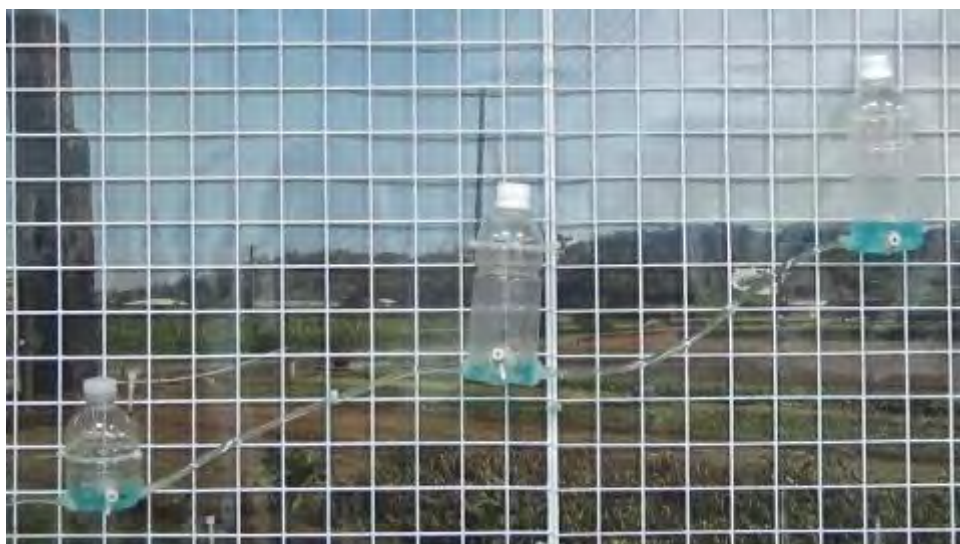
照片 5-7 第一支水煙囪 250ml 時，第三支開始灌溉的情形
