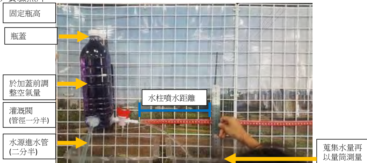
照片 5-10 氣量 0 毫升時，20 秒內灌溉水量與水柱噴出距離
