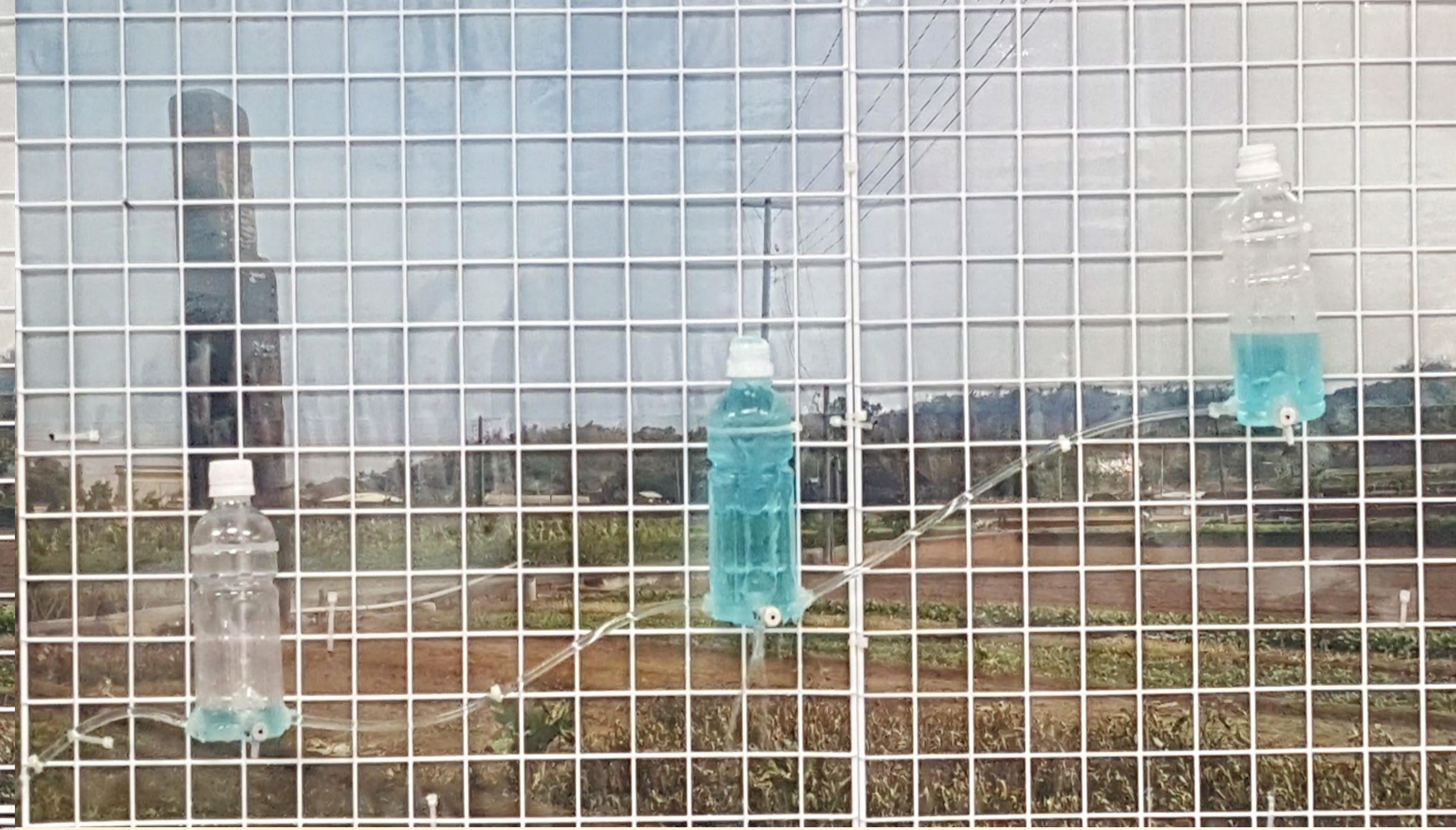
照片 6-3 實驗組第一支加蓋、第二支不加蓋水面水平面示意照
