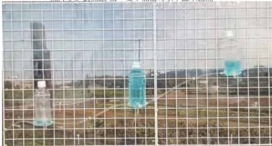
照片 6-3 實驗組第一支加蓋、第二支不加蓋水面水平面示意照
