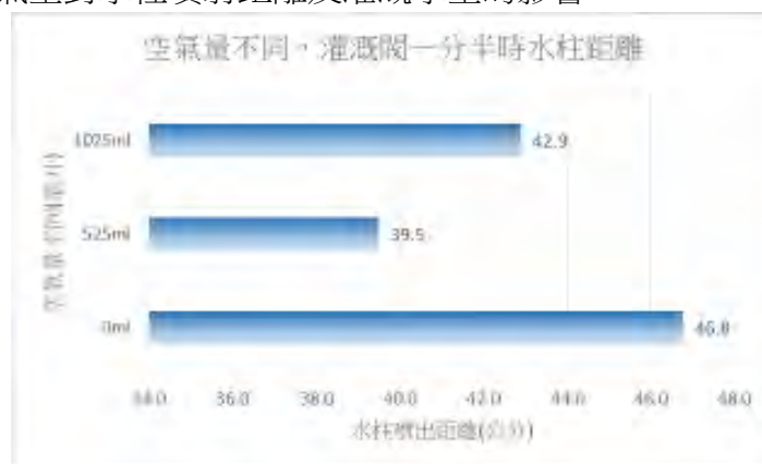
圖 6-10 單支水煙囪內空氣量不同-噴出距離(灌溉閥 1 分半時)
