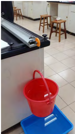
圖十九：生物可分解塑膠測試平行拉力強度
