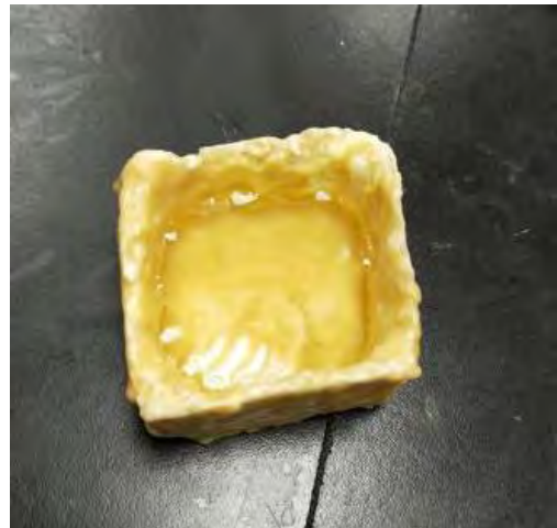
圖二十四：生物可分解塑膠塗蜂蠟後裝水
