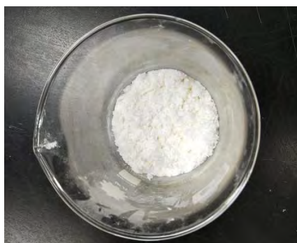
圖十三：浸泡於氫氧化鈉溶液中製成的魚鱗粉較為細緻。
