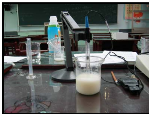
圖一：0.01M HCl+優酪乳的測定裝置
