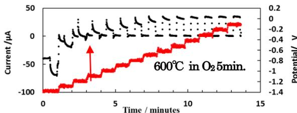
**Fig.18**  $\text{Ta}_2\text{O}_5$  : Xe lamp, Pt, 0.10 mol/L  $\text{Na}_2\text{SO}_4$
