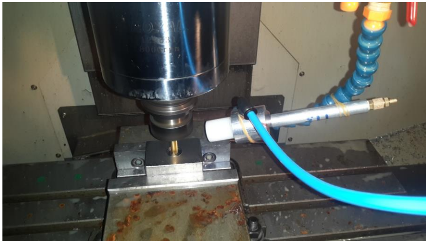
(圖四十) 渦流管排屑狀況示意圖
