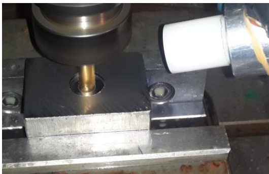
(圖四十一) 鐵屑完整排除
