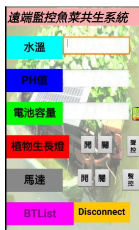
圖（三十八）自行設計的手機監控畫面
