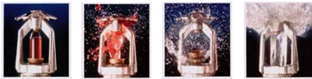
圖 4 溫度感測爆破型玻璃球閥灑水頭爆破之情形
