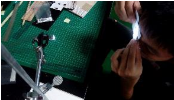
(圖 1-35、利用紙顯微鏡觀察懸浮微粒)
