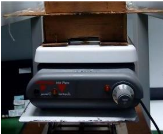
(圖 1-26、電熱盤加熱氣室)
