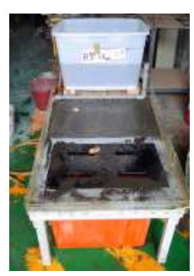
仿鐵製 R 型水溝蓋防蚊排水試體遭細砂石掩蓋
