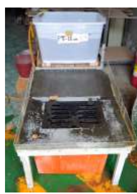
仿鐵製 Q 型水溝蓋防蚊排水試體遭細砂石掩蓋
