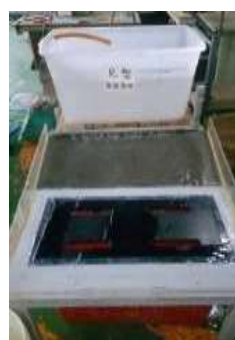
R 型水溝蓋無廢磚級配 試體測試實驗
