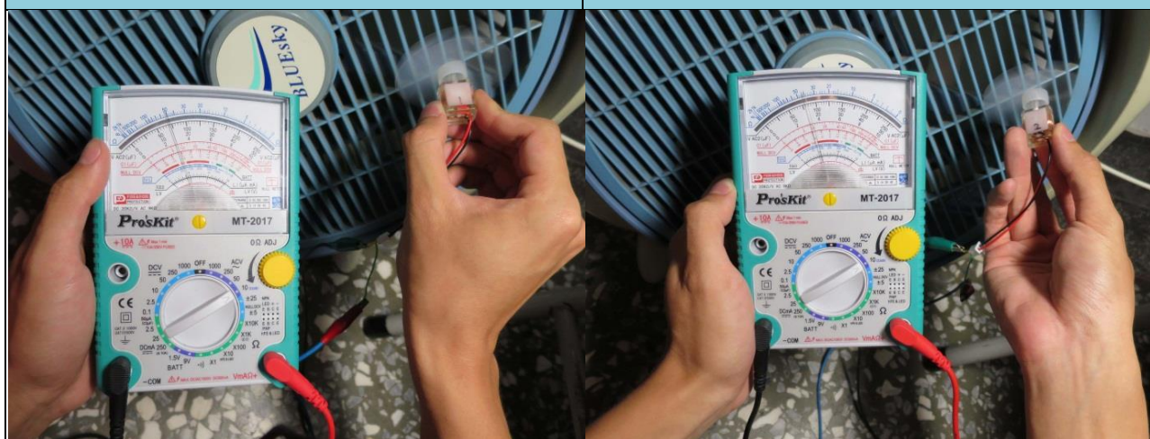
圖(七) 風力發電機 1 電風扇測試
