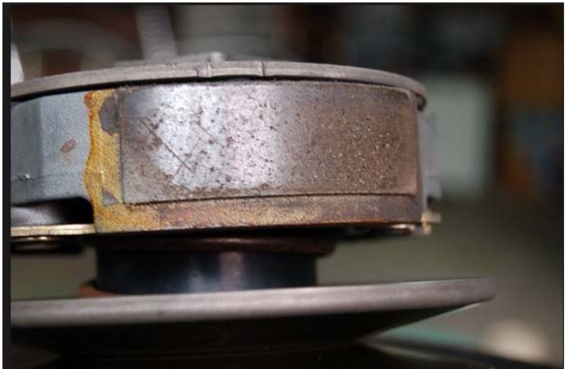
圖(19)因為蹄片磨耗完全而須整組更換的離合器
