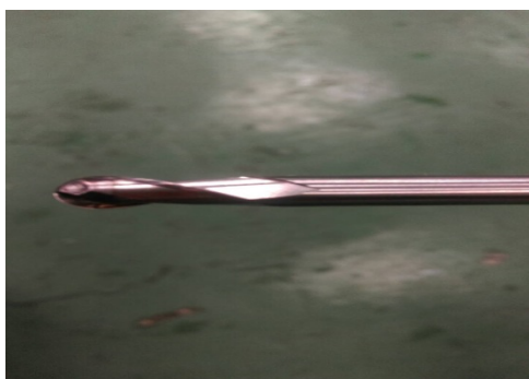
圖(15)高速鋼(HSS)刀頭部有點磨損
