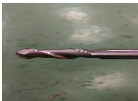
圖(16)鋁用球刀銑削鋁料無磨損
