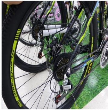
圖 6 普通腳踏車之變速裝置
