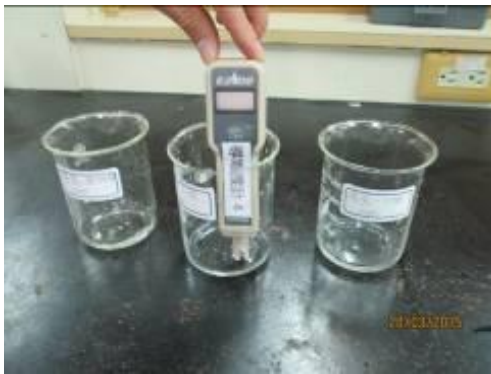
圖[5-8] 為導電度量測情形
