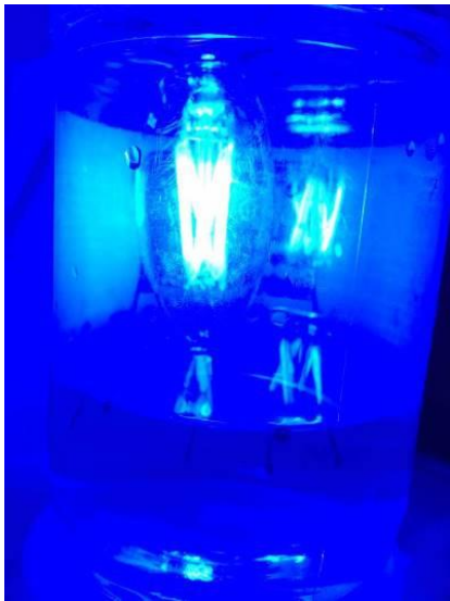
圖 6 藍光 455LED (波長 455nm, 藍光比例 91.2%)
