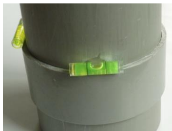
圖 9 在模擬煙囪安裝水平儀
