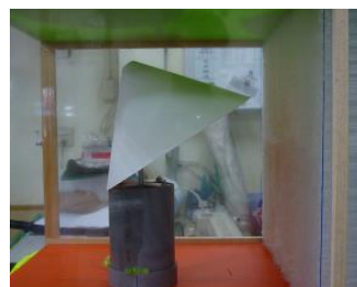
圖 23 通風蓋傾斜角度實驗
