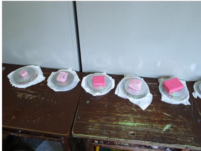
圖 18 將各重量處理改以同重量的黏土代替
