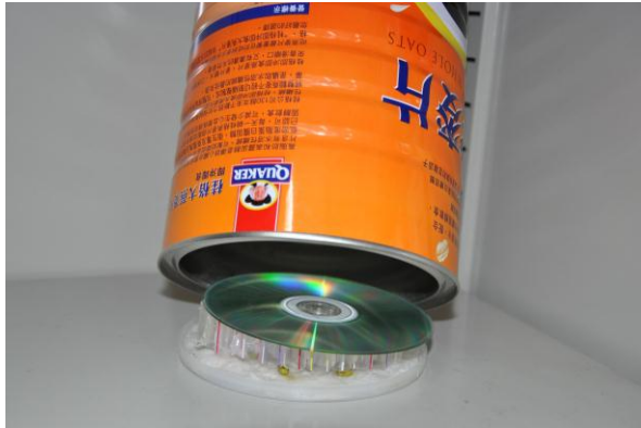
圖 16 利用燕麥罐倒過來罩住培植裝置，形成遮光較密閉生長環境
