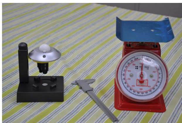
圖 1 本試驗使用測量工具，由左至右為顯微鏡、游標卡尺、磅秤。
