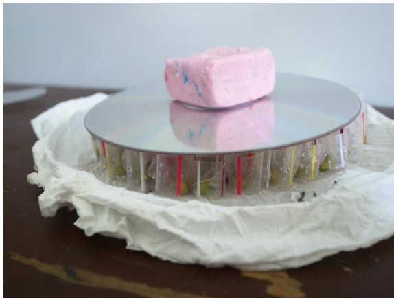
圖 17 將黏土切成處理的克數，取代砝碼壓在光碟片上
