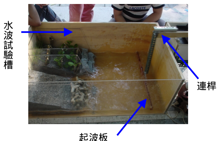
圖一、水波試驗槽裝置
