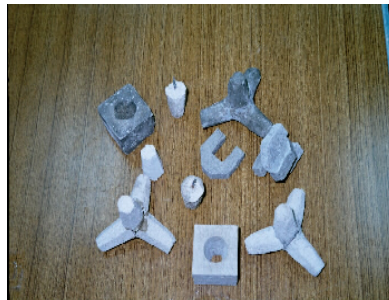
圖二、消波塊模型製作過程，以及半成品或完成模型。
