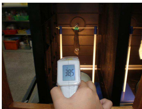
圖 9 紅外線溫度計的雷射點對準測試物
