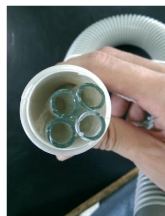
粗水管內放入根細水管
