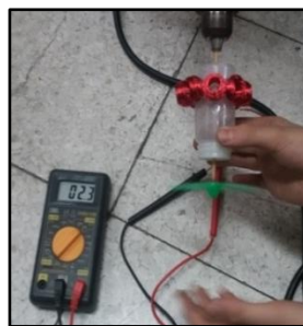
第三代發電機最大電壓 2.3V
