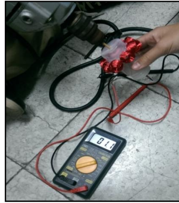
電鑽最高轉速記錄的裝置方式
