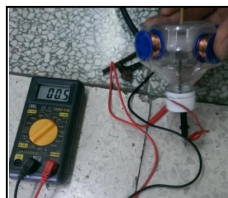
第二代發電機最大電壓 0.5V
