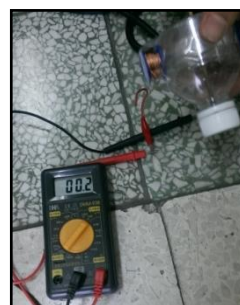
第一代發電機 最大電壓 0.2V
