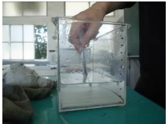
圖 5.8 筆在水中書寫測試
