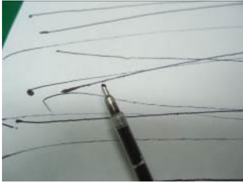
油性原子筆正立書寫高溫爆水情形
