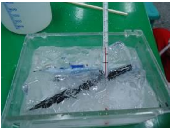
圖 5.7 筆在極低溫-14 度 C 環境施作情形 (冰+水+鹽)
