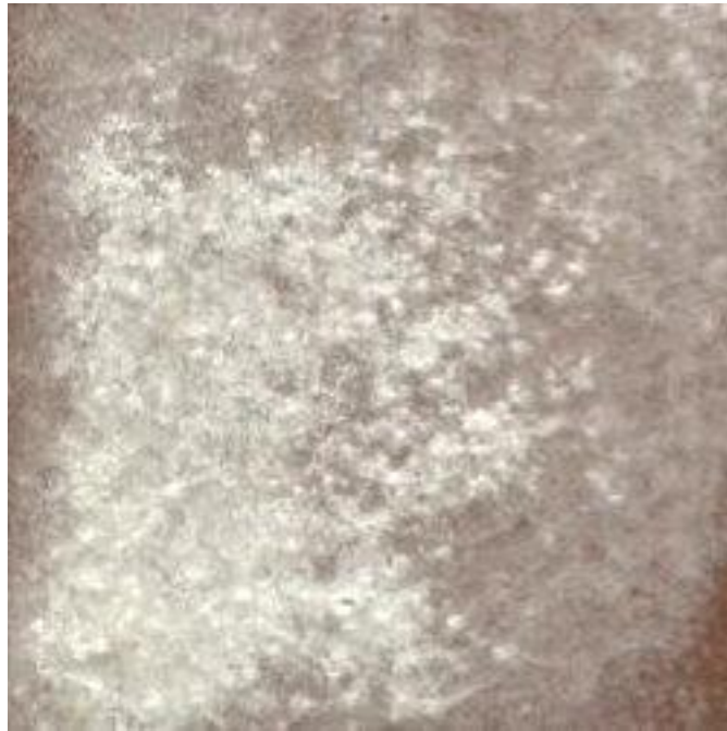
圖 7 牡蠣殼粉 30%和霞正長石 70%混合之釉藥燒成結果(1140℃)
