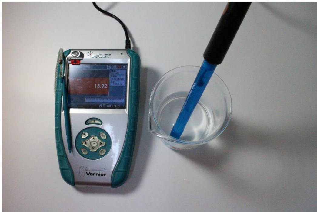
圖 10 測試氫氧化鈉水溶液之 pH 值
