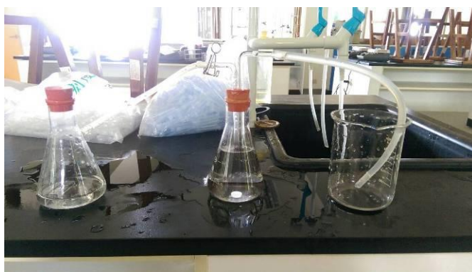
圖 10 排水集氣法實驗裝置
