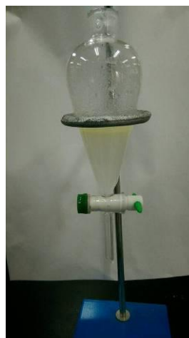
圖 8 將樣品倒入分液漏斗取水層
