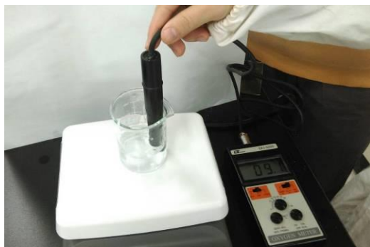
圖 11 利用溶氧計偵測水中溶氧量變化
