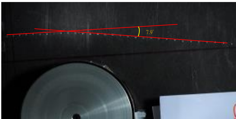
圖十九：距離引力裝置 3 cm，入射速度 154.0 cm/s。
