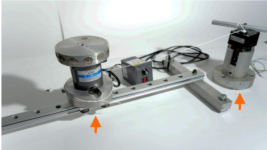
圖七：行星位移裝置
