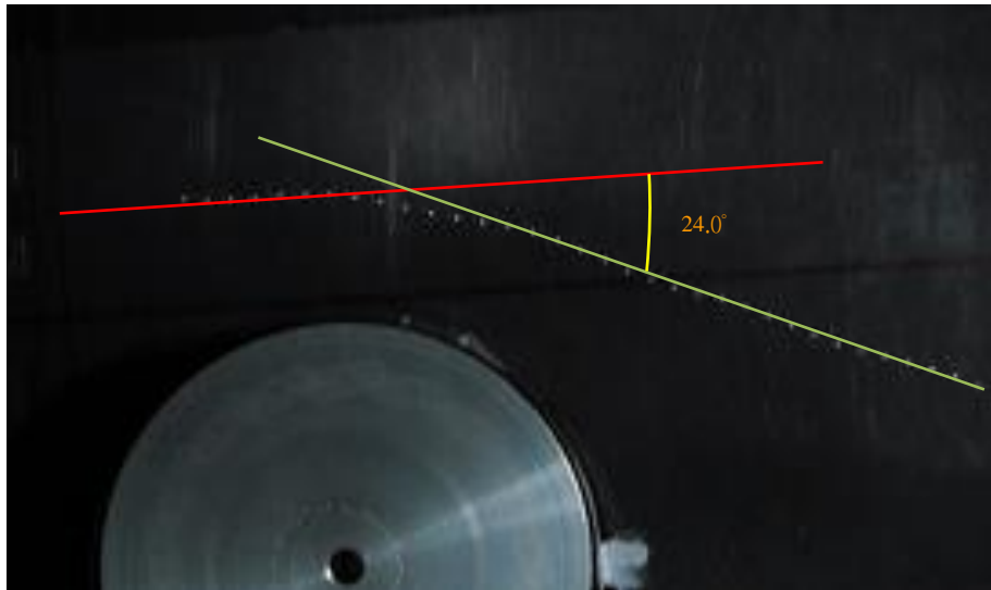
圖十一：距離引力裝置 3 cm，入射速度 84.0 cm/s。
