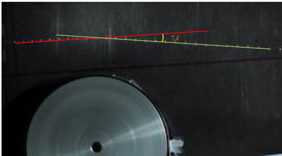
圖二十一：距離引力裝置 3 cm，入射速度 168.0 cm/s。
